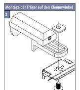
Träger ca. 5 – 7 cm vom Schienenende entfernt positionieren. Max. Abstand zwischen den Trägern 70 cm. Bitte beim Positionieren der Träger auf freie Funktion der Kipp-Beschläge des Fensterflügels achten.
